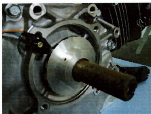
Figura 3.7 – Posicionamento do sensor de velocidade
