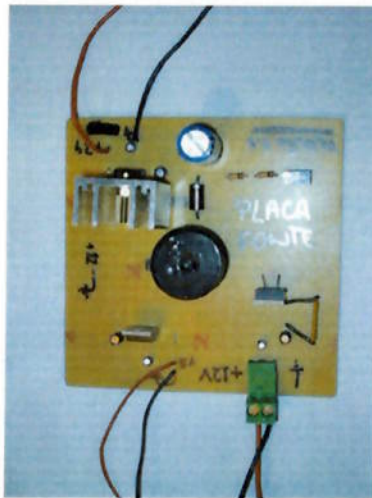
Figura 3.31 – Protótipo do circuito de alimentação
